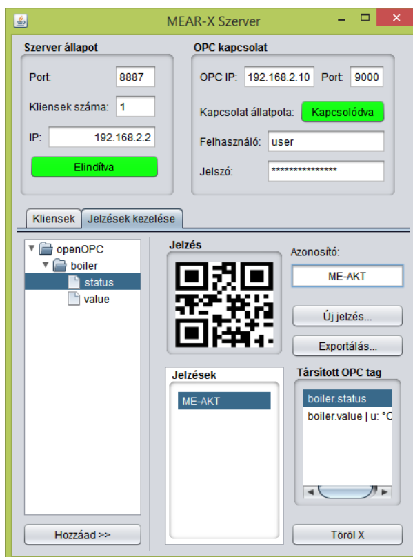
25. ábra Központi kiszolgáló, jelzések összerendelése
