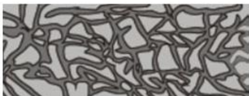
Rendezetlen struktúrájú kőzetgyapot – egyenlő szárú, összezsomózott szálak a termék teljes térfogatában
