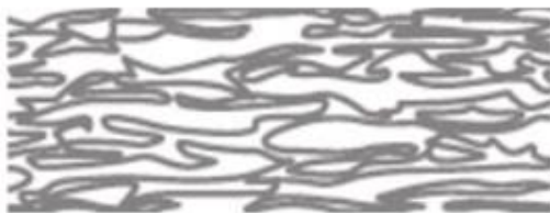
Lamellás struktúrájú kőzetgyapot – a szálak vízszintes elhelyezése
