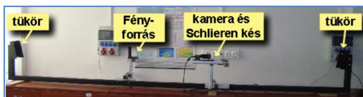
11. ábra : Z- típusú Schlieren mérőrendszer [14]
