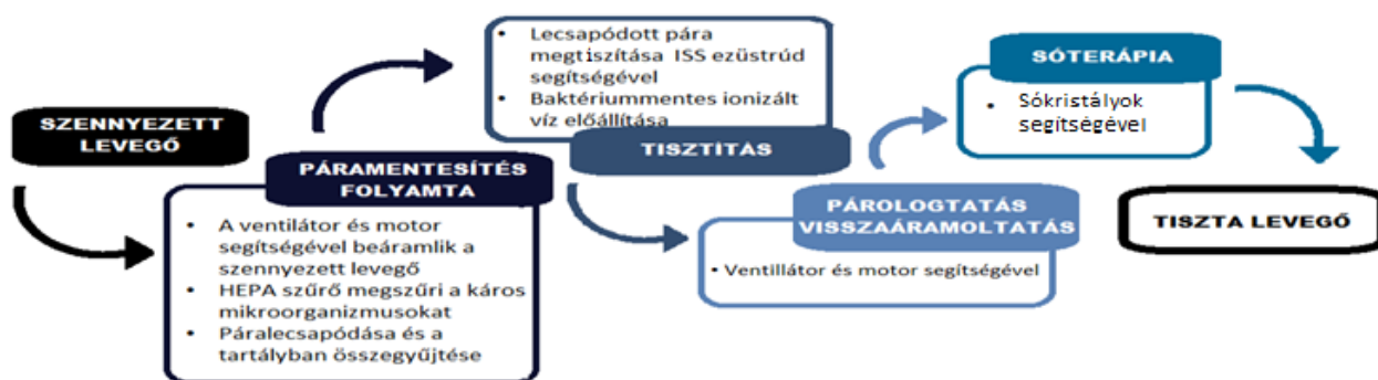
21. ábra A levegő tisztításának folyamatábrája
