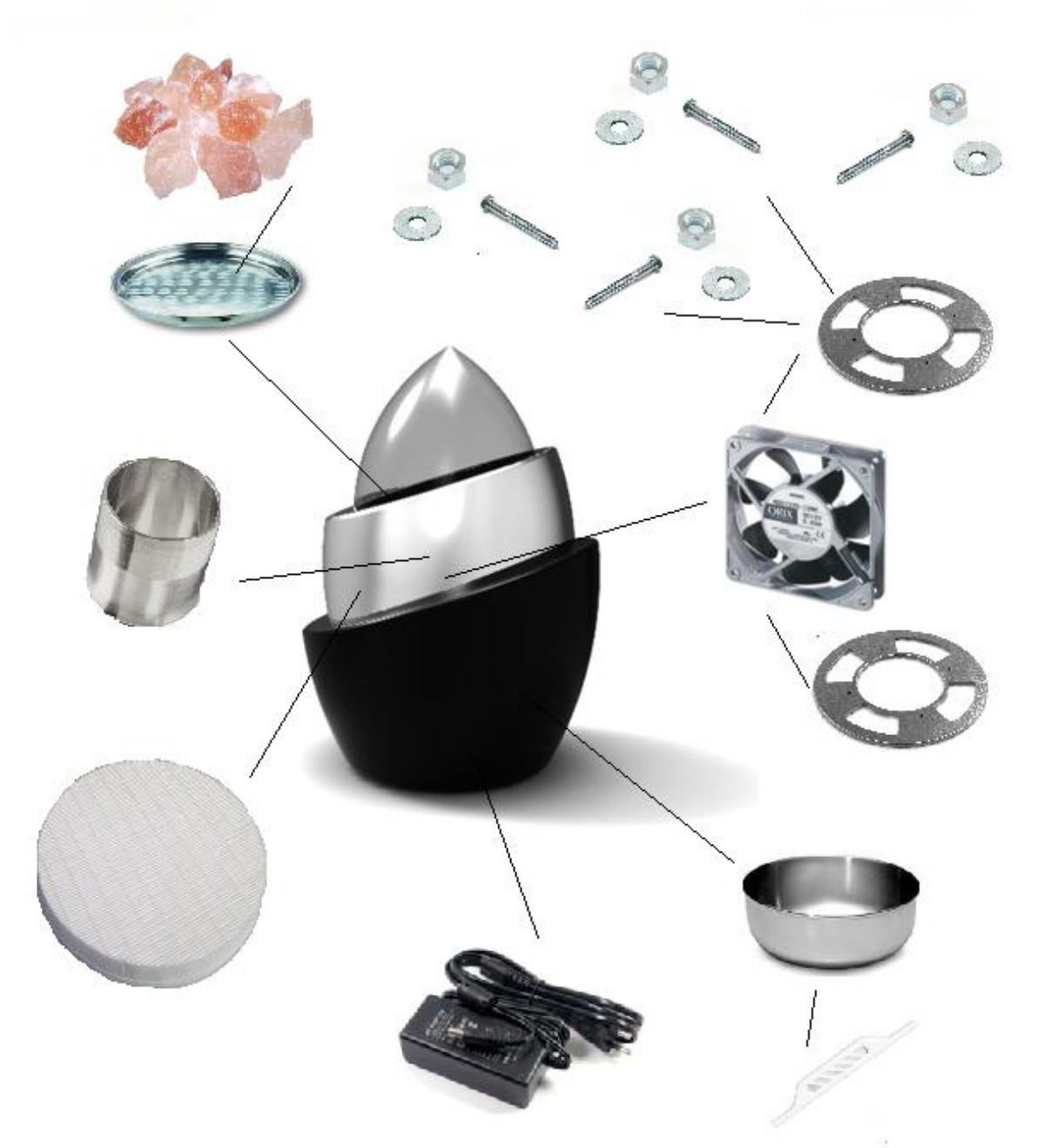
33. ábra A végső változat robbantott ábrája
