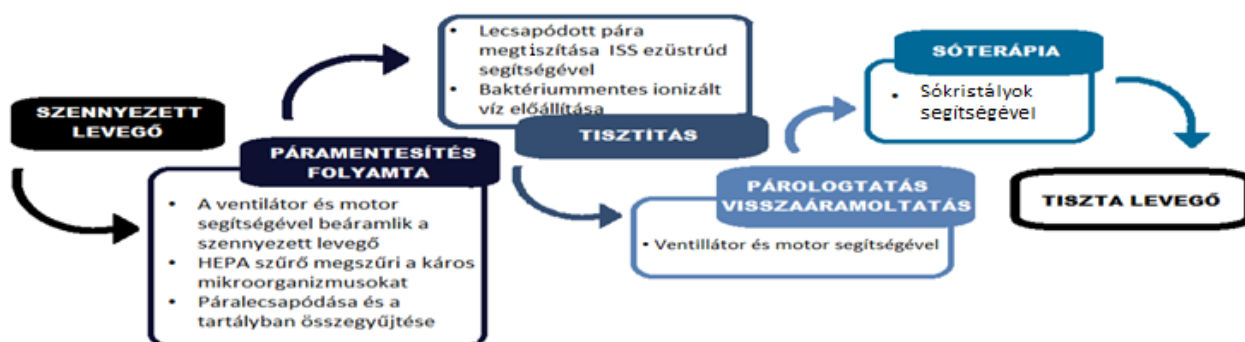
21. ábra A levegő tisztításának folyamatábrája
