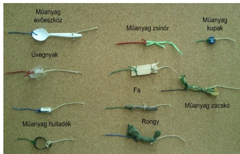
33. ábra. Alternatív szigetelők
