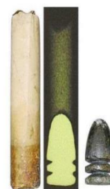
2. ábra Lorenz féle kompressziós lövedék és papírtöltény
