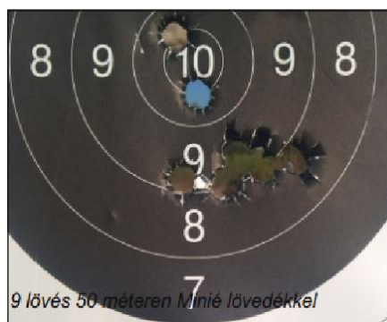
3. ábra 9 lövés 50 méteren Minié lövedékkel
