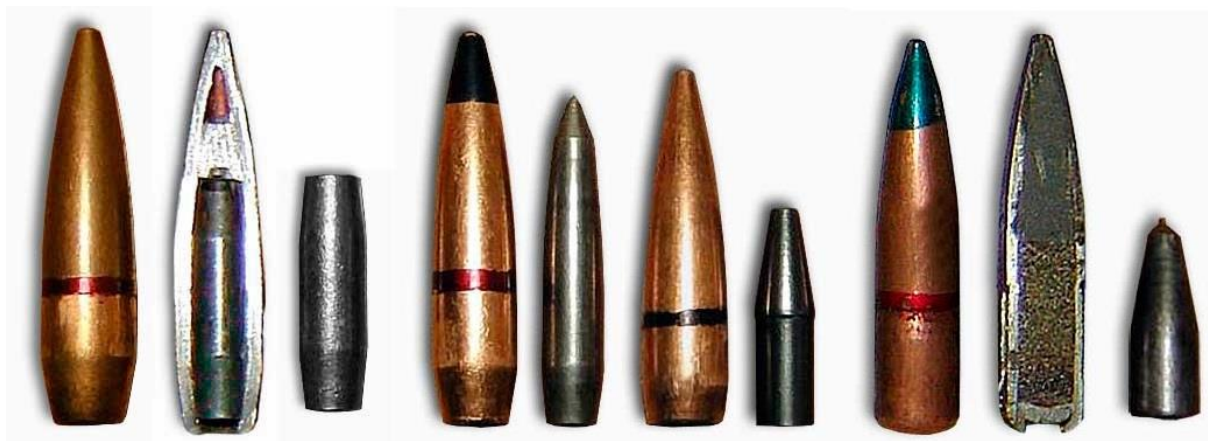
10. ábra 5,45×39 mm-es PS, BP, BS, T löszerek (balról jobbra, metszetekkel)
