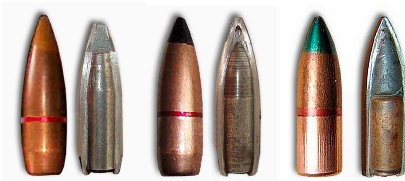
13. ábra 7,62×39 mm-es PS, BS, T-45 lőszer (balról jobbra, metszetekkel)
