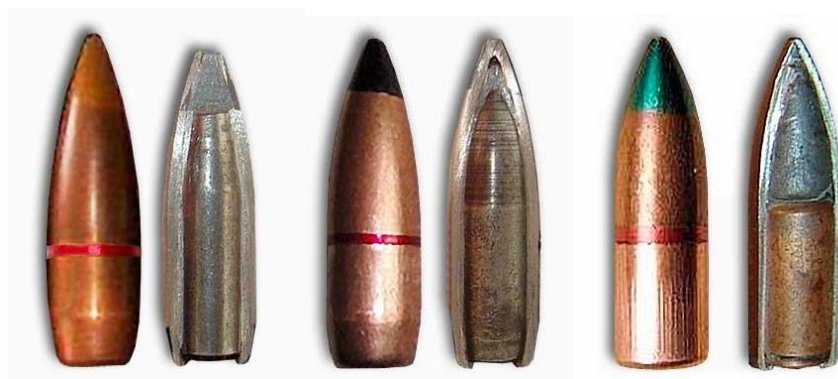
13. ábra 7,62×39 mm-es PS, BS, T-45 löszerek (balról jobbra, metszetekkel)
