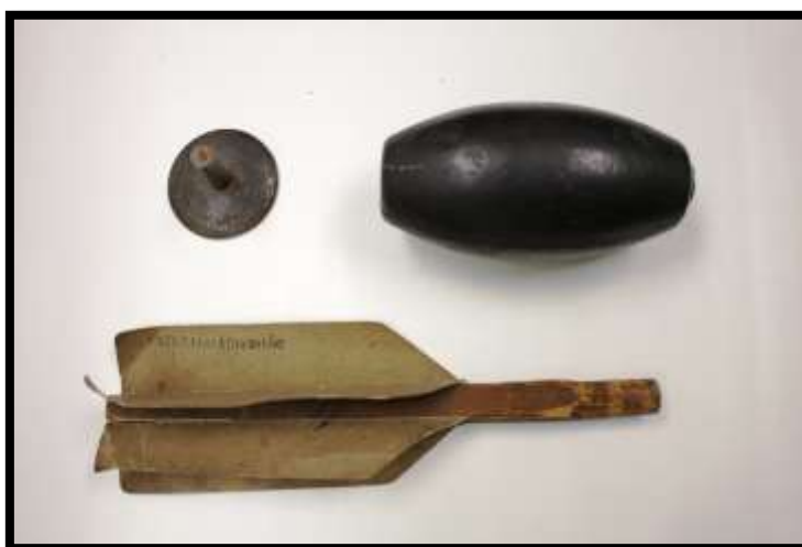
2. ábra: Az ütőszeg a tányérral, az öntöttvas gránáttest és a stabilizáló szárny 13
