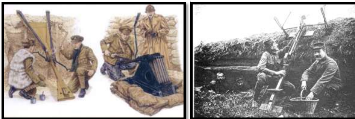
12. ábra: A Leach-féle bombavető- és a West-féle hajítógép grafikája (balra), valamint egy korabeli fénykép a vetőgépről (jobbra) 76
