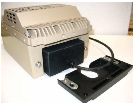
7. kép: TMP akkumulátor adapter (az adapter az akkumulátorrekeszbe van behelyezve, látható a módosított akkumulátorrekesz-fedél is)
