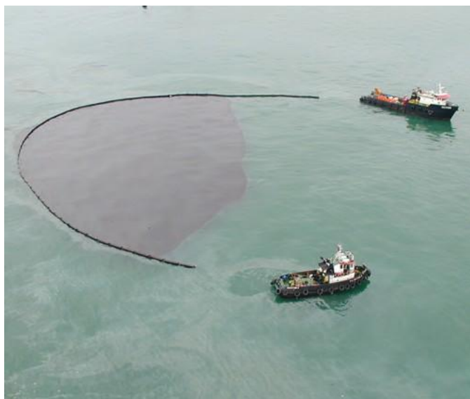
23. kép: Vontatott falak alkalmazása 45
