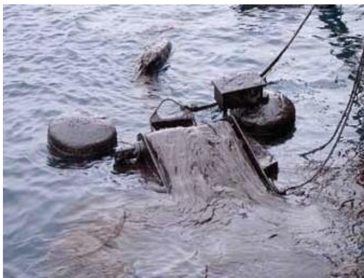
25. kép: Skimmer működés közben 48
