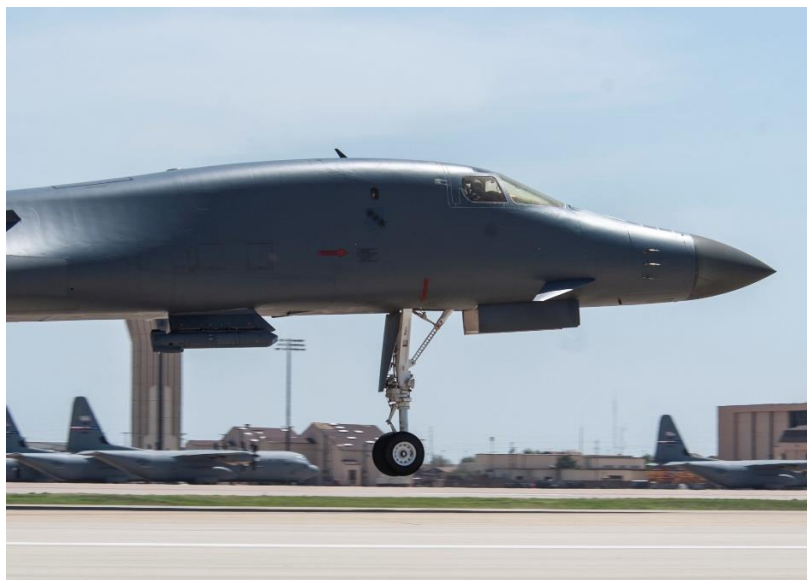
5. ábra: B-1 Lancer bombázó, törzsre rögzített Sniper-SE célfelderítő és célmegjelölő konténerrel 16 .
