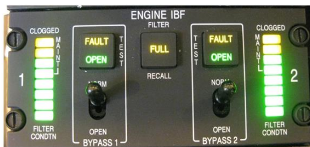
17. ábra Kabin visszajelzés az IBF eltömődéséről és a megkerülő nyílás nyitásáról 22
