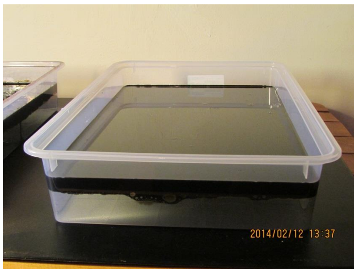
5. ábra. Tározó vízzel és olajszennyeződéssel
