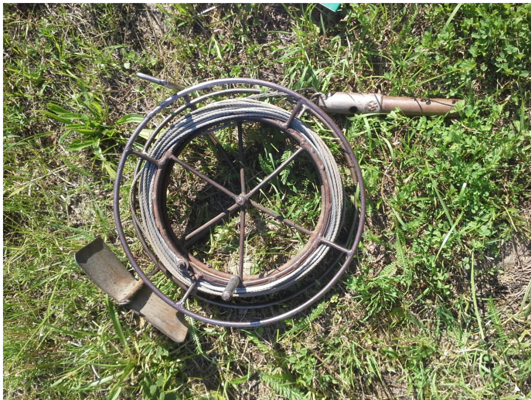
13. ábra: Sípóló talajvízszintmérő
