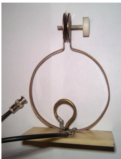
7. ábra. A hangolható mágneses antenna elvi rajza és fényképe
