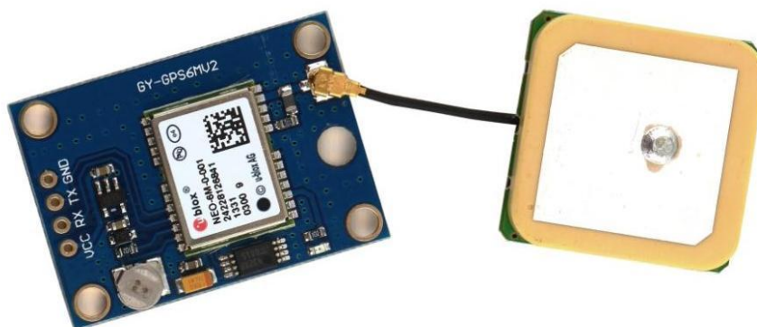
14. ábra. Az U-BLOX NEO-6M modul fényképe
