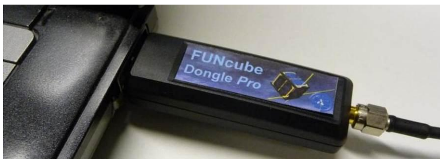
11. ábra. A használt rádióvevő és csatlakoztatása a laptop-hoz
