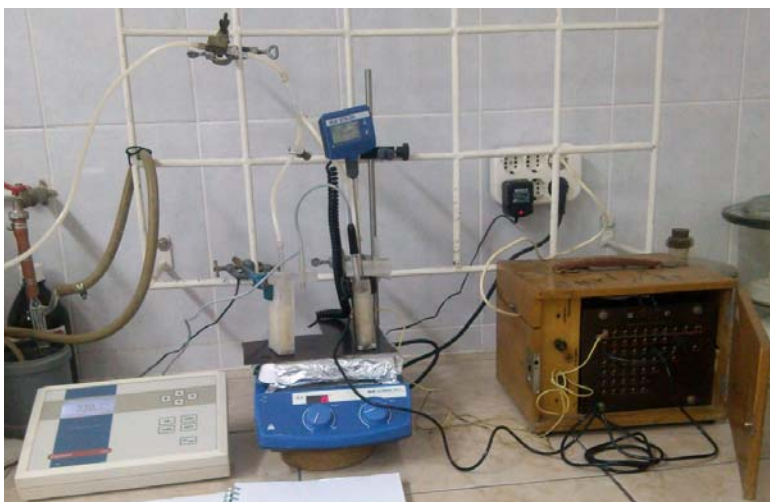
12. ábra. Az élesztő-metabolizmus tanulmányozási kísérlet berendezése (50 Hz-es feszültség kapcsolása a jobboldali edényre)
