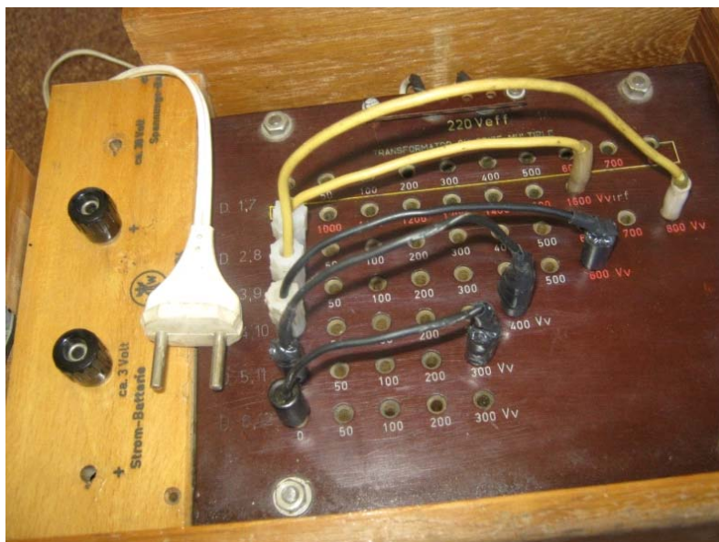
8. ábra. A csatlakozóssal ellátott feszültségemelő transzformátor
