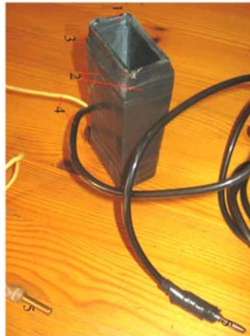
1. ábra. A kísérleti reaktorok: 1 – az edény fala; 2 – elektromos szigetelés; 3 – síkpárhuzamos elektródák; 4 – kapcsolóhuzalok; 5 – elektromos csatlakozások.
