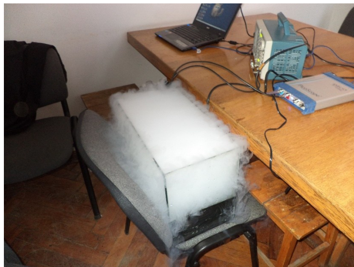
4. ábra: A kísérleti eszközök. Az akváriumban folyékony nitrogénes víz az alacsony hőmérséklet eléréséhez
