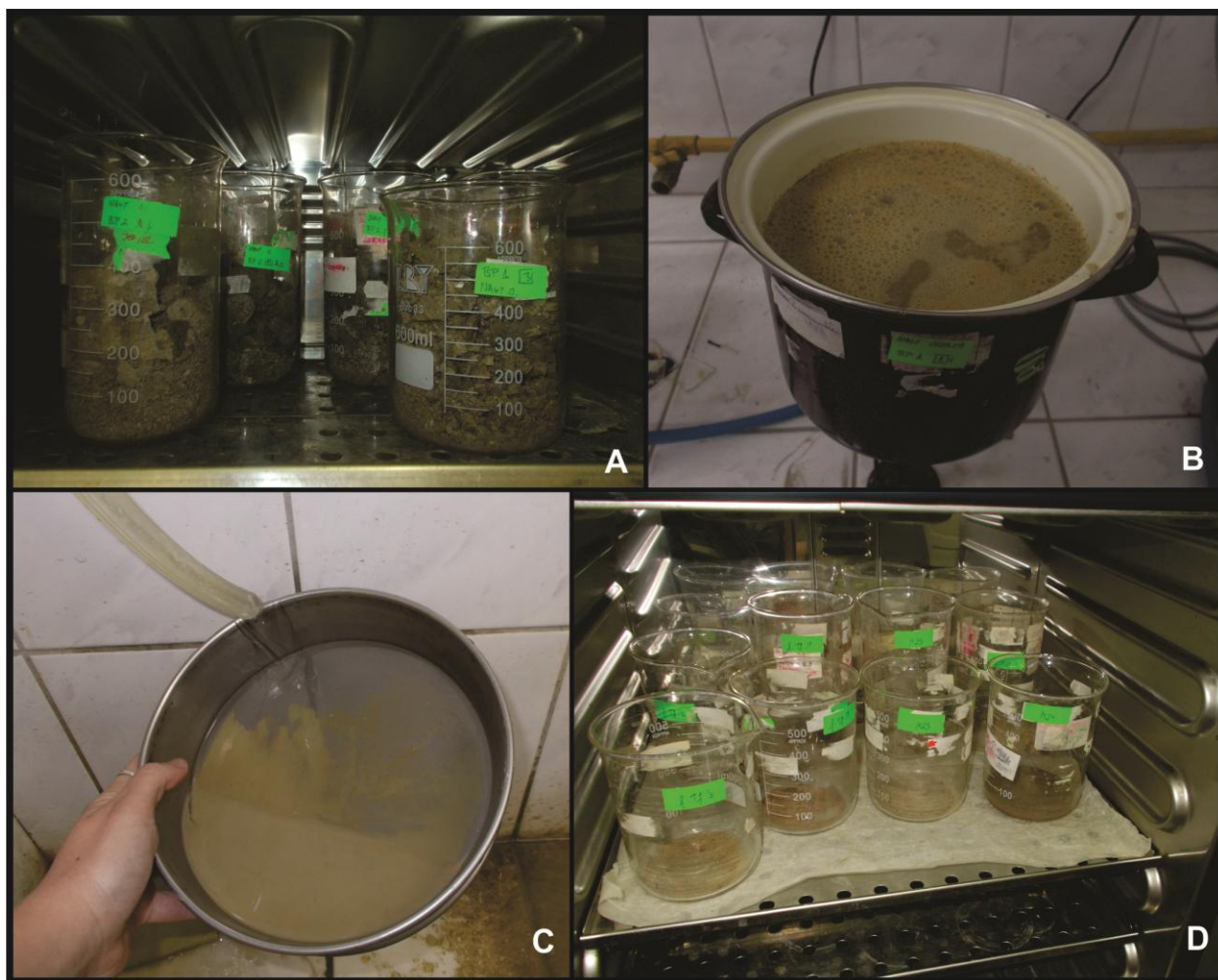
7. ábra. A mintafeldolgozás lépései: A – a kimérendő anyagmennyiség 90–95 °C fokon való kiszárítása; B – a minta kifőzése a közet kompaktációjának megszüntetése céljából, \text{NaHCO}_3 (nátrium-hidrogénkarbonát; szóda-bikarbóna) hozzáadásával; C – az agyag frakció eltávolítása, a nedves szitálás módszerével; D – az iszapolási maradékok kiszárítása.
