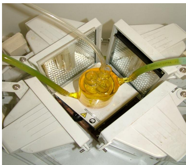
3. ábra: Látható fénnel (Vis) működő fotoreaktor
