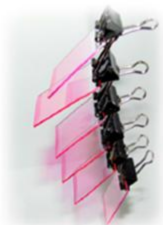
2.13. Ábra : rodamin 6G-vel inkubált pórusos szilika bevonat
