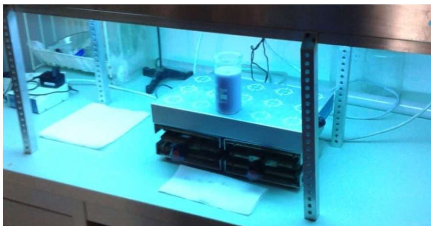
8. ábra: Arany nanorészecskék fotoredukció általi szintéziséhez használt berendezés
