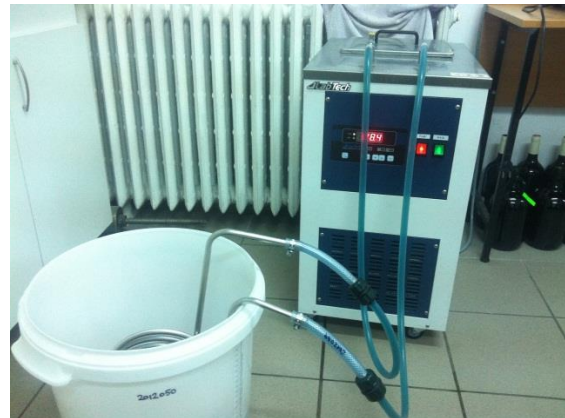
A must főzése valamint a sörlé hűtése.
