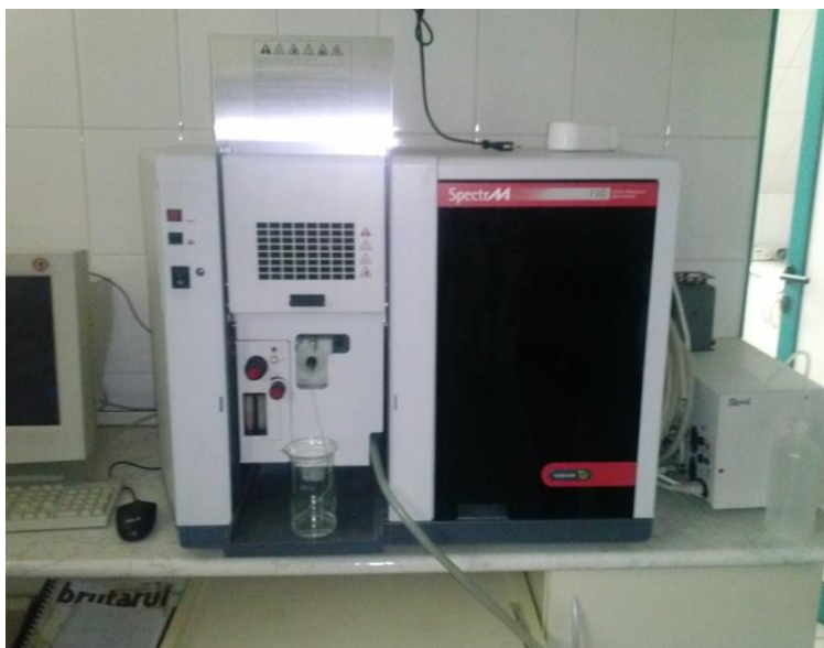
7.ábra. Varian Spektra AA 110 típusú atomabszorpciós spektrofotométer
