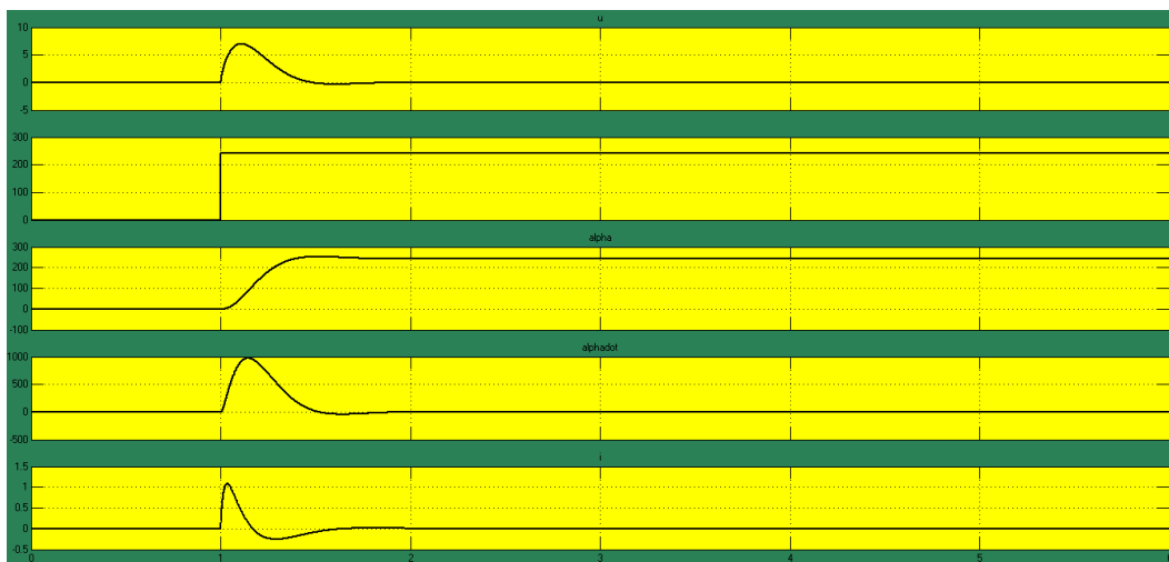
45. ábra: LQ szabályozás q[0,1e-6,1e-8,0.01];r[0.01235] súlyozás esetén
