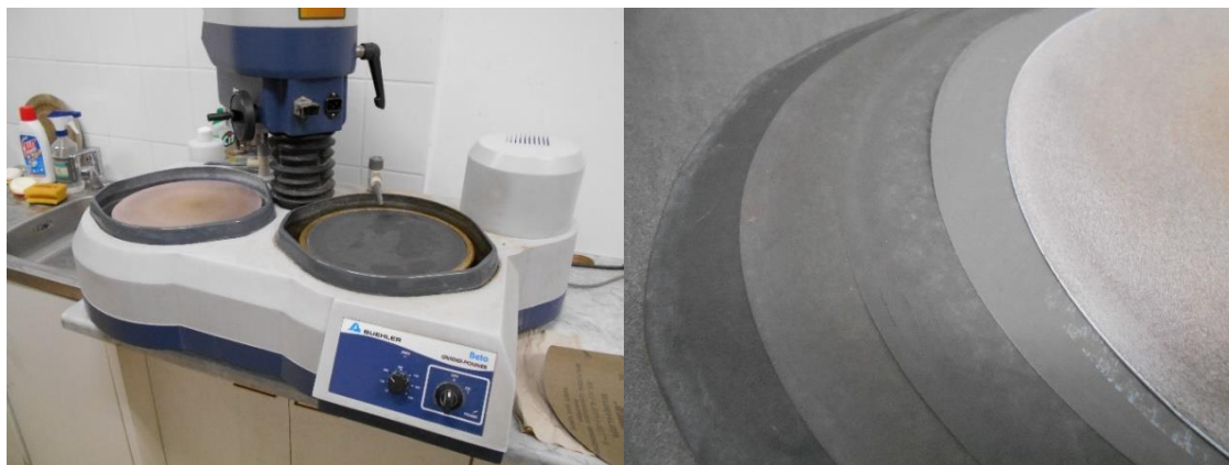
22. ábra: Csiszoló, polírozó gép és a felhasznált korongok
