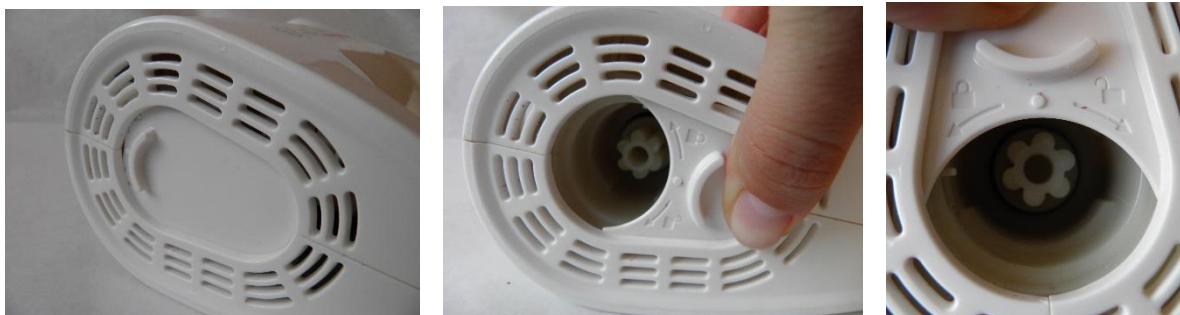
28. ábra: Gép hátsó részén a hajtás
