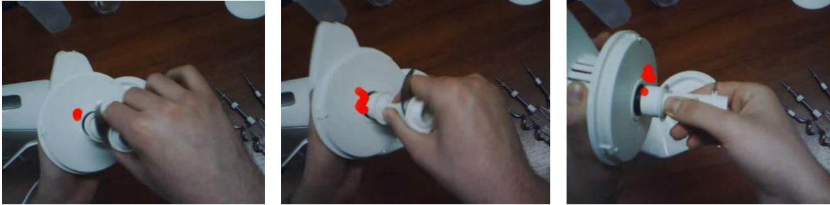
39. ábra: Aprítókés behelyezése a tálba – helytelen használat
