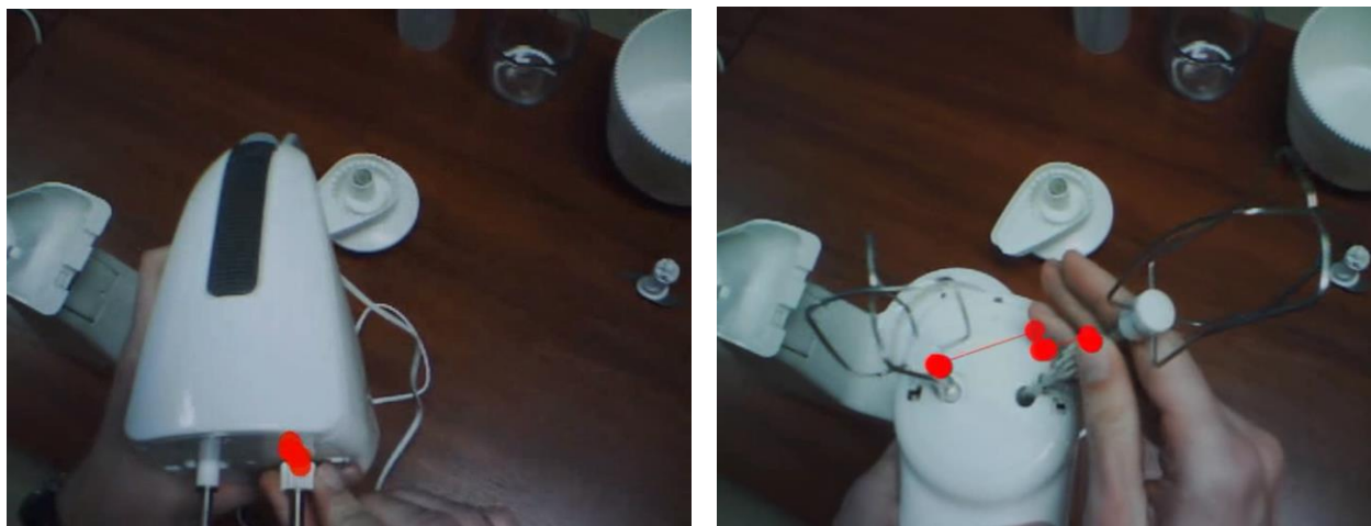
30. ábra: A keverőszárak helyes behelyezése - helytelen használat
