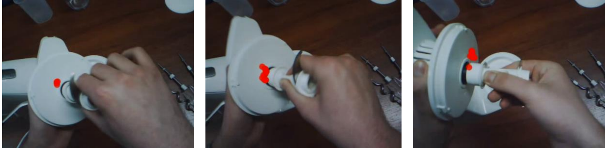
39. ábra: Aprítókés behelyezése a tálba – helytelen használat
