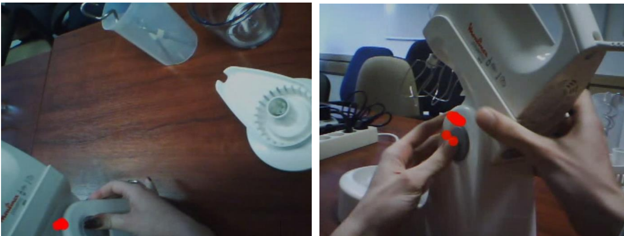
36. ábra: Az állvány le-/ felhajtása – helyes használat
