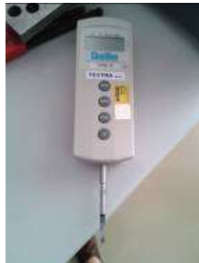
5. ábra: Erőmérőre erősített körömsablon.
