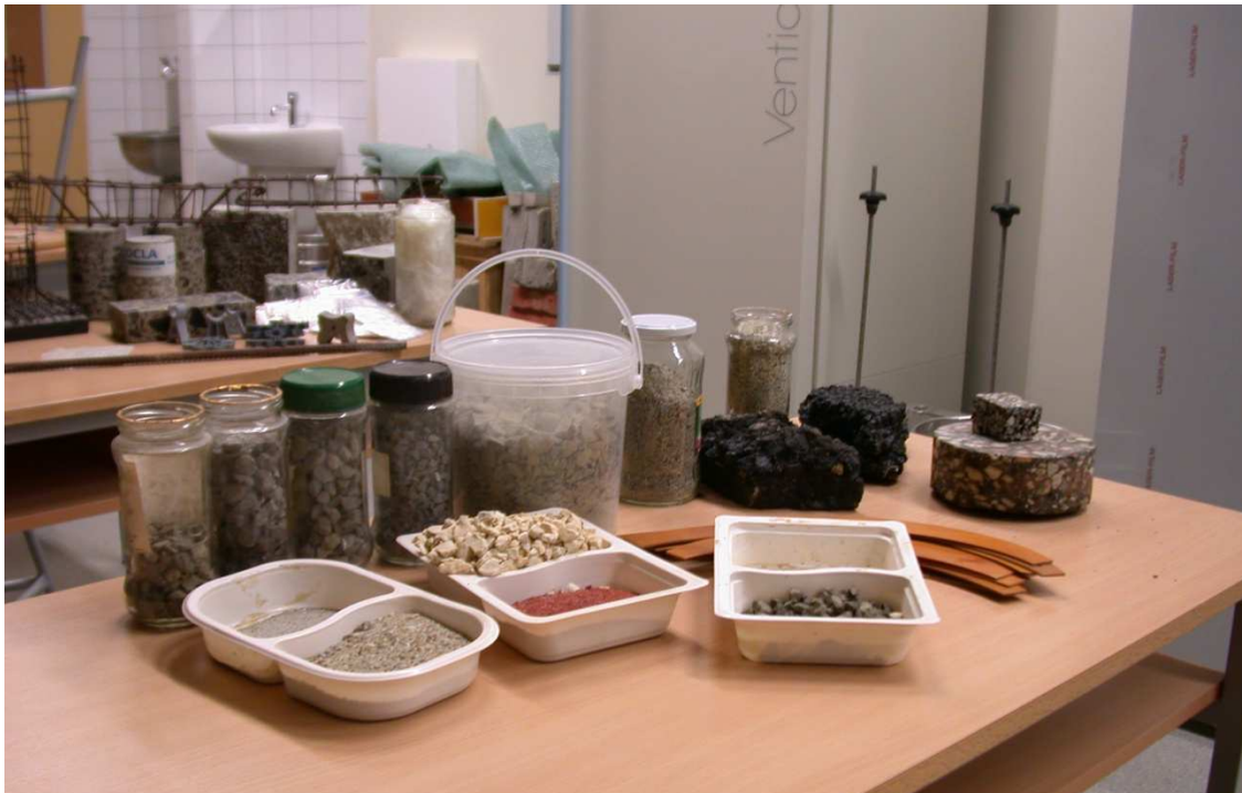
57. ábra: Aszfaltminták, adalékanyagok [Saját forrás.]
