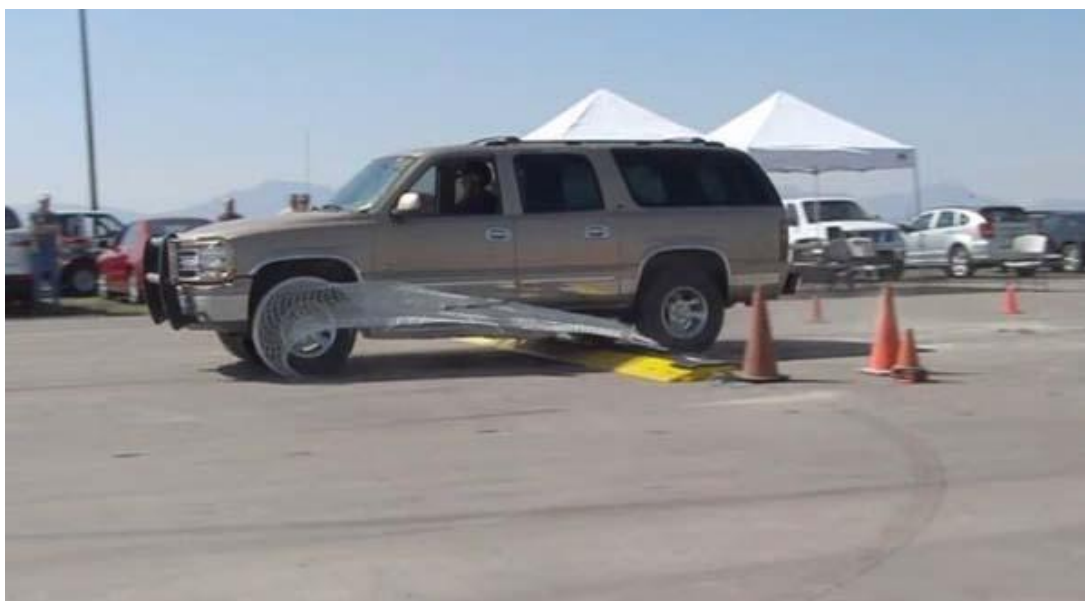
34. ábra: az elfogó háló működés közben forrás: http://lopjatokazotteleimet.posttr.hu/cimke/SQUID
