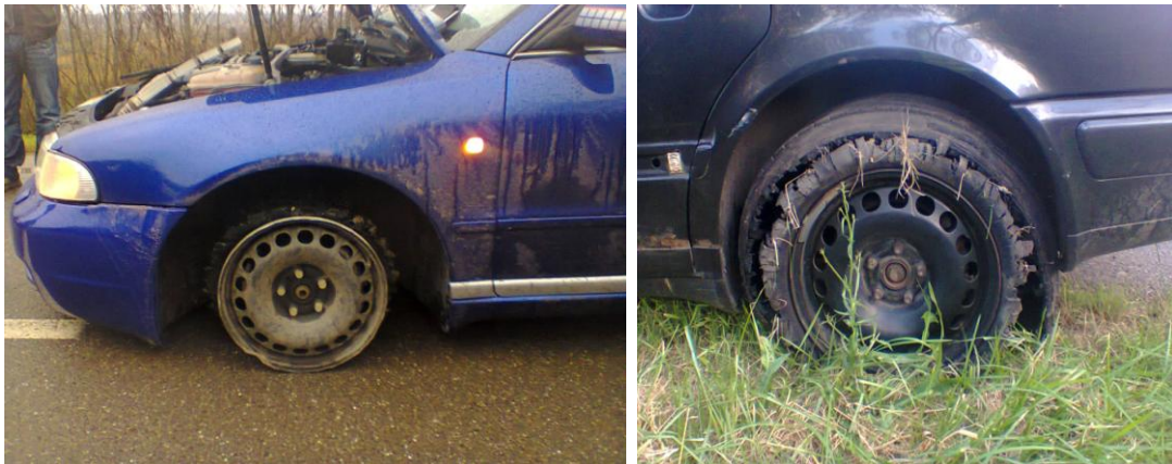
29-30. ábrák: Az útzár alkalmazásának következtében keletkezett rongálódások (források: Kölcse Határrendészeti Kirendeltség)
