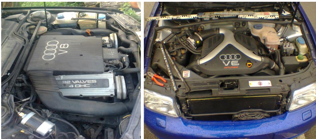
21-22. számú ábrák: Audi S6 Avant 4.2 V8 motortere és Audi S4 Avant 2,7 V6 biturbo motortere (források: Kölcse Határrendészeti Kirendeltség)
