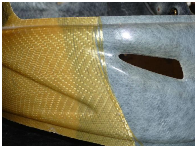
12. ábra Három különböző szövet felhasználásával készül a trikompozit sisak
