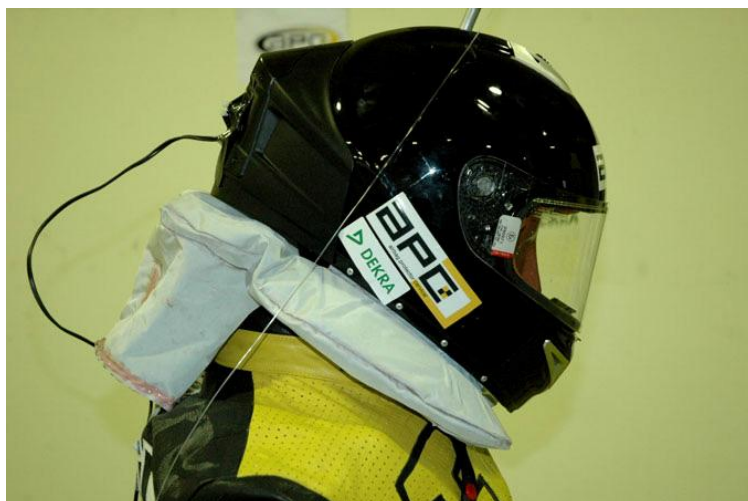
23. ábra Ilyen, amikor kinyílik a légsák. Hátul a nyaknál a 7. nyakcsigolyáig véd, az orvosi tapasztalatok szerint a lefedett felső rész a legkritikusabb 59
