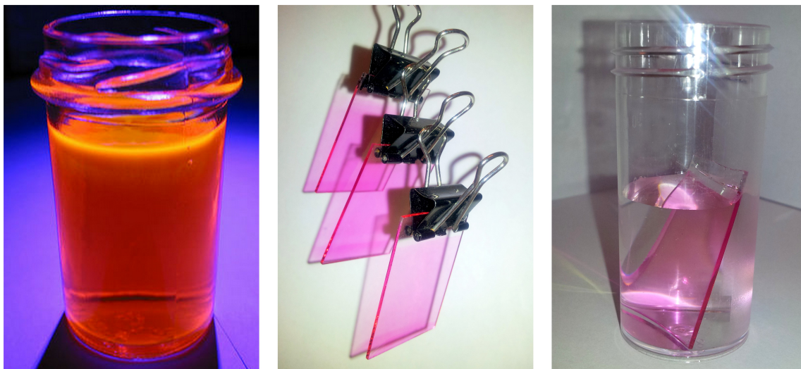
4.3. ábra. Balról jobbra haladva: az inkubálás során használt Rodamin 6G színezék vizes oldata, az inkubált pórusos szilikarétegek üveg hordozón, valamint a színezék leadásának vizsgálata.
