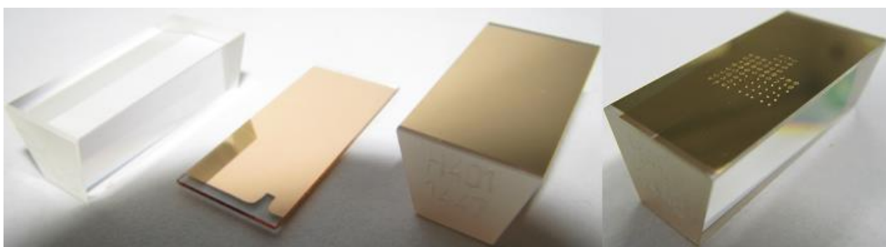
19. ábra – Prizma, Slide és BioChip. A jobb oldali szenzorchipen jól láthatóak a felcseppentett PNS foltok.
