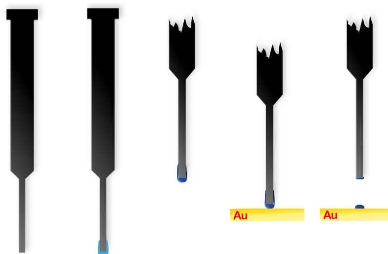
16. ábra – A cseppentés során a tű belemerül a PNS-oldatot tartalmazó mikrotiter tálca üregeibe, és a tű végére egy apró oldatcsepp kerül. A robotkar a szenzorchip fölé pozicionálja a tűt, majd hozzáérinti az arany felülethez, így a PNS szálakat tartalmazó csepp a szenzorchip felületére kerül.
