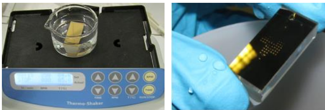
21. ábra – BioChip blokkolása 1 mM-os MCH-oldatban (PBS). A jobb oldalon látható, hogy a BioChip tisztításakor a felületre permetezett víz a cseppentett pontokat nedvesíti, míg máshonnan leperreg.
