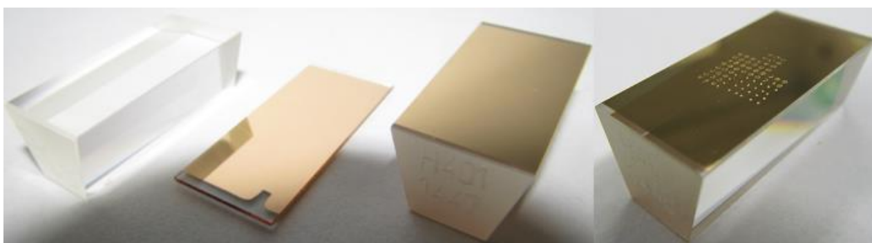
19. ábra – Prizma, Slide és BioChip. A jobb oldali szenzorchipen jól láthatóak a felcseppentett PNS foltok.
