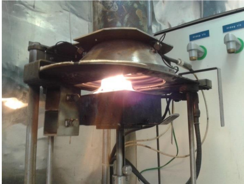
16. ábra: Mass Loss (Cone) kaloriméter az égő kompozittal
