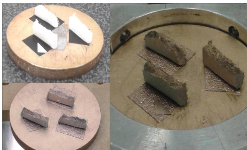
20. ábra: A három minta elhelyezkedése a mintatartón aranyozás előtt és után
