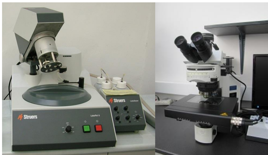
13. ábra: Struers LaboPol-5 polírozó berendezés és Olympus BX51M optikai mikroszkóp
