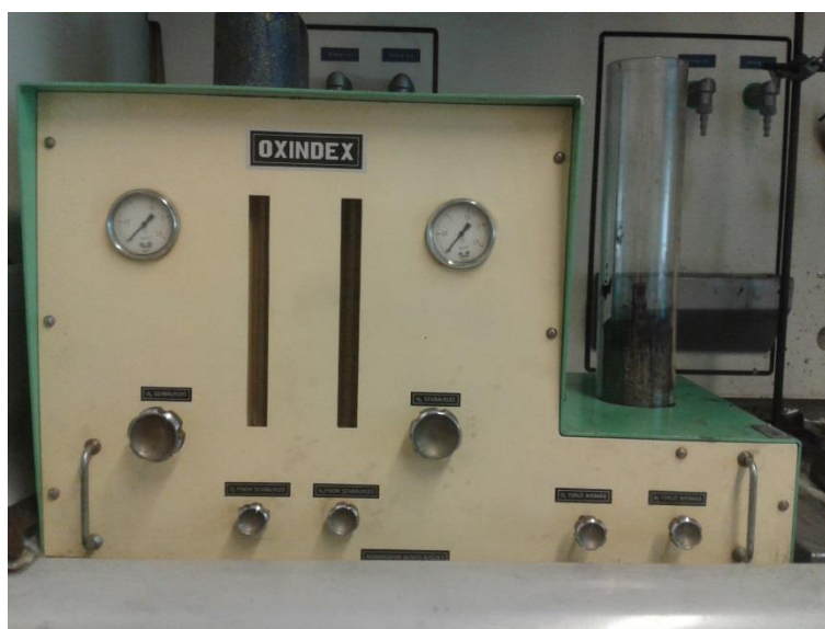
15. ábra: Oxigén index mérőberendezés
