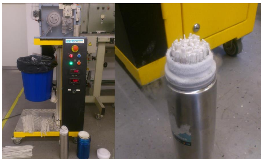
9. ábra: Labtech LZ-120/VS granuláló berendezés, hűtés folyékony nitrogénben
