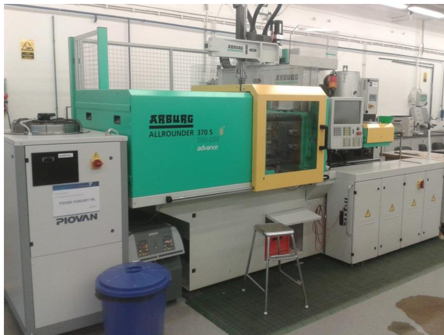
11. ábra: Arburg Allrounder 370 S berendezés
