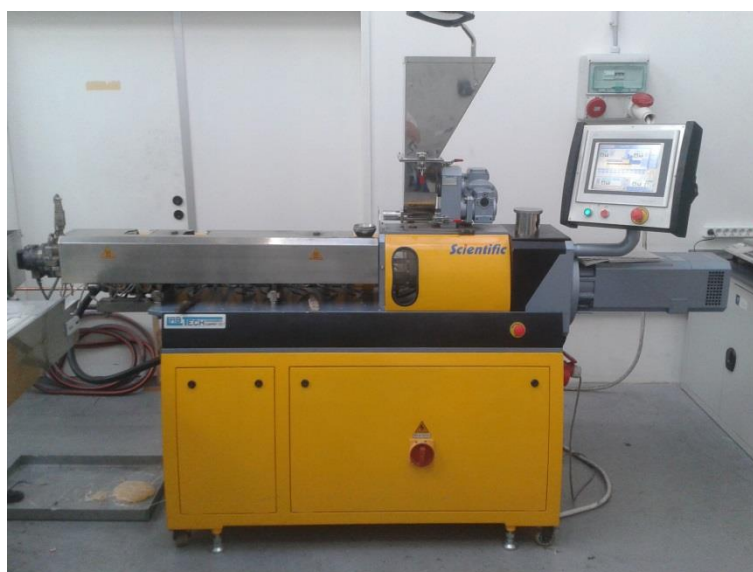
6. ábra: Labtech Scientific LTE 26-44 ikercsigás extrúder
