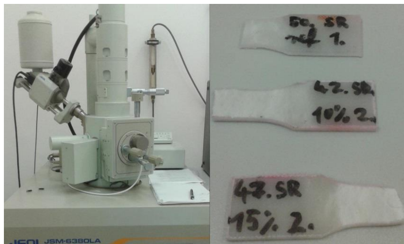
19. ábra: JEOL JSM-6380LA készülék és a vizsgálandó szakított próbatestek
