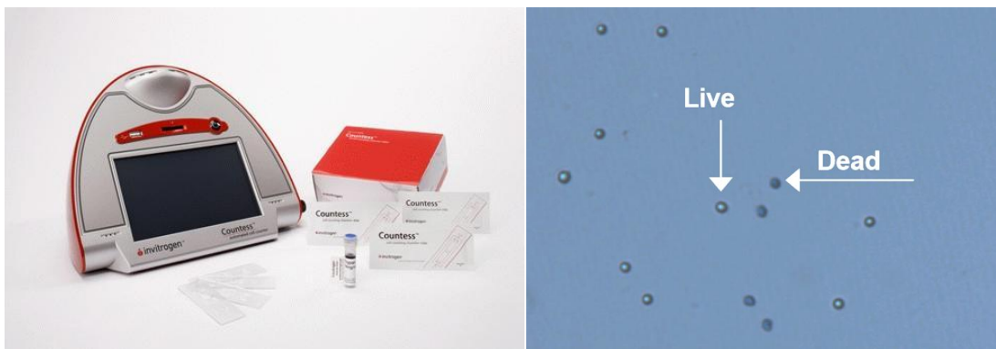
5. ábra: Countess™ Automated Cell Counter berendezés és a tripánkékel festett emlőssejtek képe. A készülék hivatalos mérési tartománya 10^4 – 10^7 sejt/ml közötti, a legjobb érzékenységet az 1 \cdot 10^5 – 4 \cdot 10^6 sejt/ml koncentrációknál garantálja.[44] (katalógusfotó: www.invitrogene.com )
