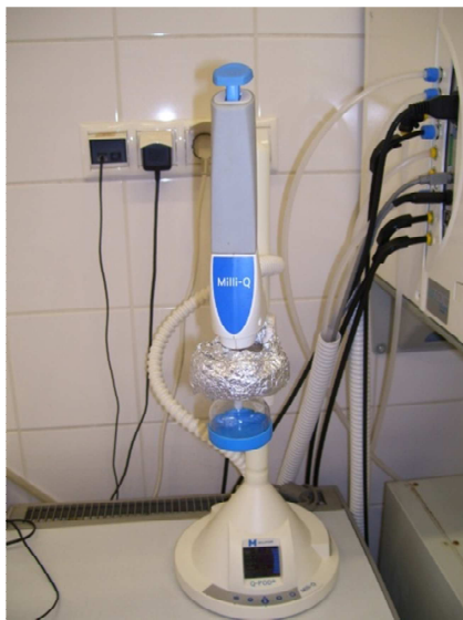
10. kép Millipore víztisztító berendezés (Kántor, 2014)
