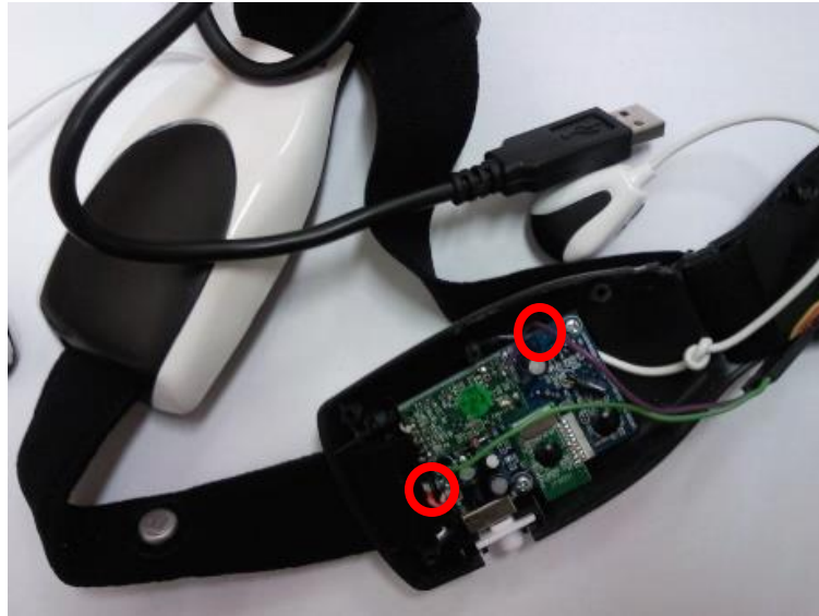
4. ábra: USB UART átalakító MindFlex EEG headset-tel történő összekötése
