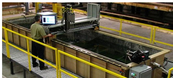
13. ábra: Ipari méretű LTI Immersion tank [8]
