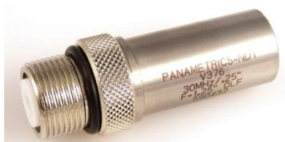
18. ábra V376-SU típusú 30 MHz-es fókuszált vizsgáló fej [13]
