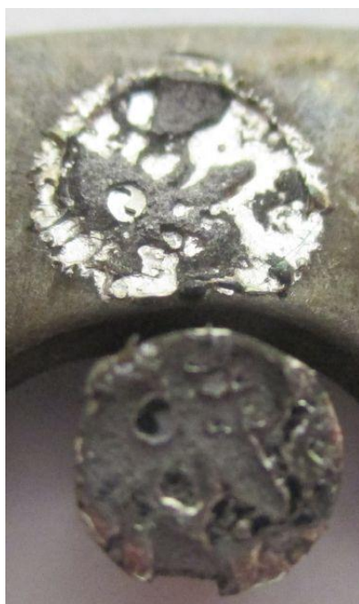
41. ábra Letört csap keresztmetszete és a kialakult zárványok
