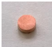
20. ábra, Forgácsolással majd hűtés közbeni vágással kimunkált 5 mm átmérőjű minta.
