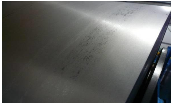
23. kép. Sűrű koromfeltapadás (sávban) (0,5x)
