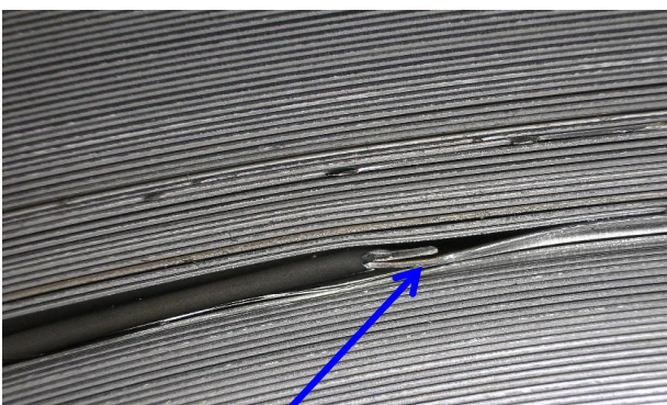
63. kép. Szélrálapolódás (0,5x)
