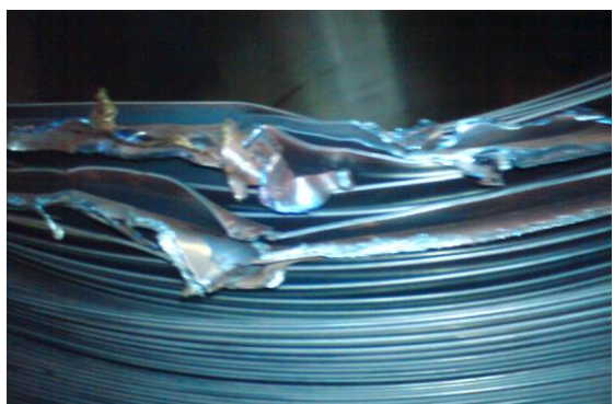
62. kép. Tört gyúrt szél (0,5x)
