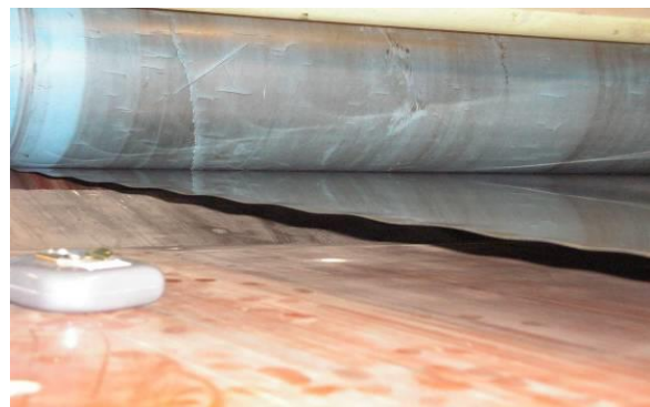
76. kép. Szélfodor átcsevélés közben (0,25x)
