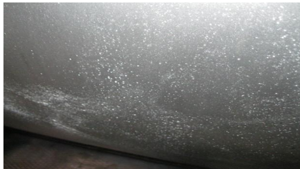
19. kép. Homoktól eredő benyomódás (0,5x)
