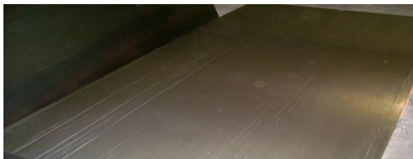
14. kép. Hengerfeltapadásból eredő karc (0,5x)
