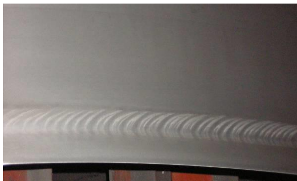
31. kép. Sávban összesült, folyásvonal a tekercs szélén (0,5x)
