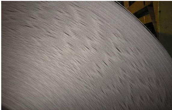
75. kép. Szélfodor a tekercsben (0,25x)
