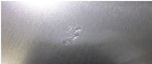
20. kép. Benyomódás (0,5x)
