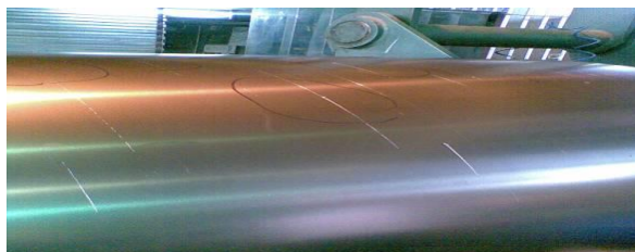
15. kép. Görgő beállásból eredő karc (0,5x)
