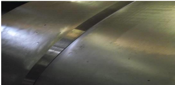
28. kép. Kötöző szalag okozta benyomódás (0,5x)
