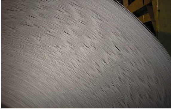
75. kép. Szélfodor a tekercsben (0,25x)
