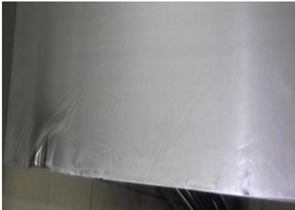
26. kép. Gyűrődés a tekercs szélénél (0,5x)
