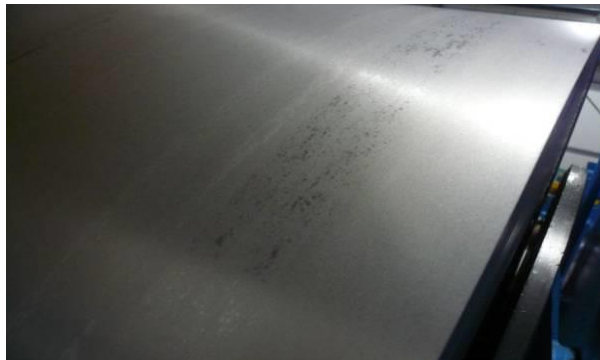
23. kép. Sűrű koromfeltapadás (sávban) (0,5x)
