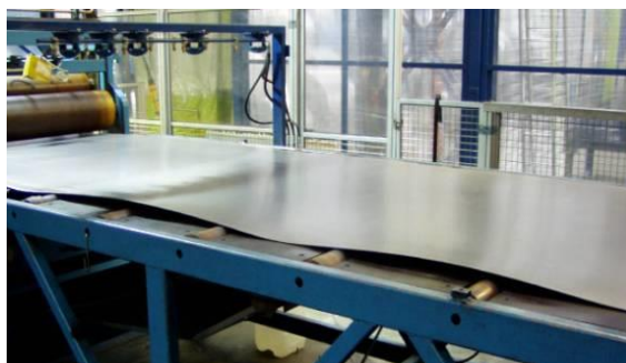
71. kép. Szélhullám (0,25x)
