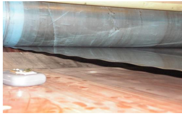
76. kép. Szélfodor átcsévlés közben (0,25x)
