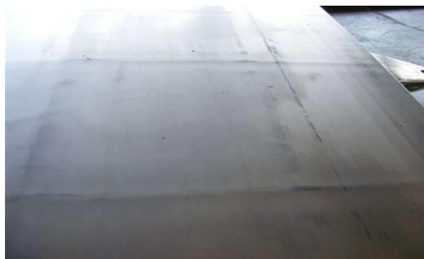
43. kép. Lecsévéelő okozta törésvonal (0,5x)
