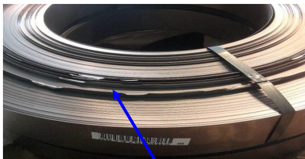
61. kép. Teleszkóp miatti tört-gyúrt szél (0,25x)
