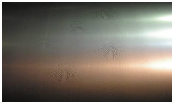
30. kép. Elszórt összesülés nyomok a tekercs felületén (0,5x)
