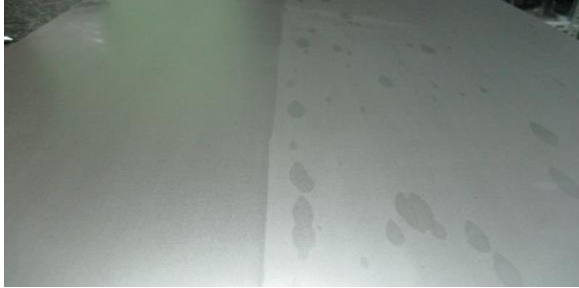
51. kép. Érdesség eltérés (0,25x)
