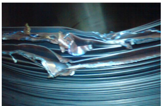
62. kép. Tört gyúrt szél (0,5x)
