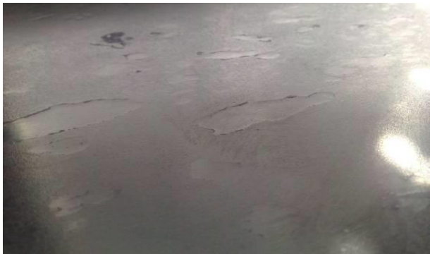
22. kép. Erős koromfeltapadás (0,5x)
