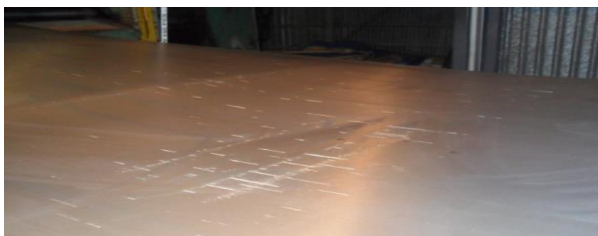
16. kép. Menetmegcsúszásból eredő karc (0,5x)
