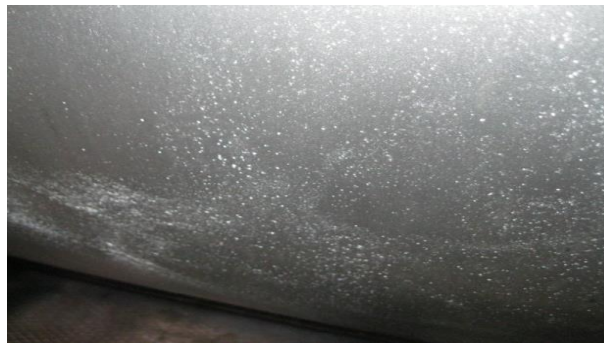
19. kép. Homoktól eredő benyomódás (0,5x)
