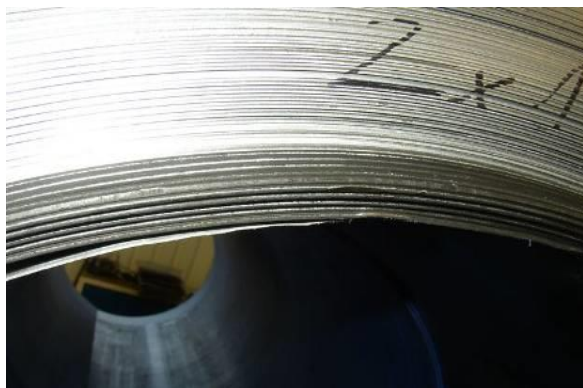
64. kép. Széleztelen (0,5x)
