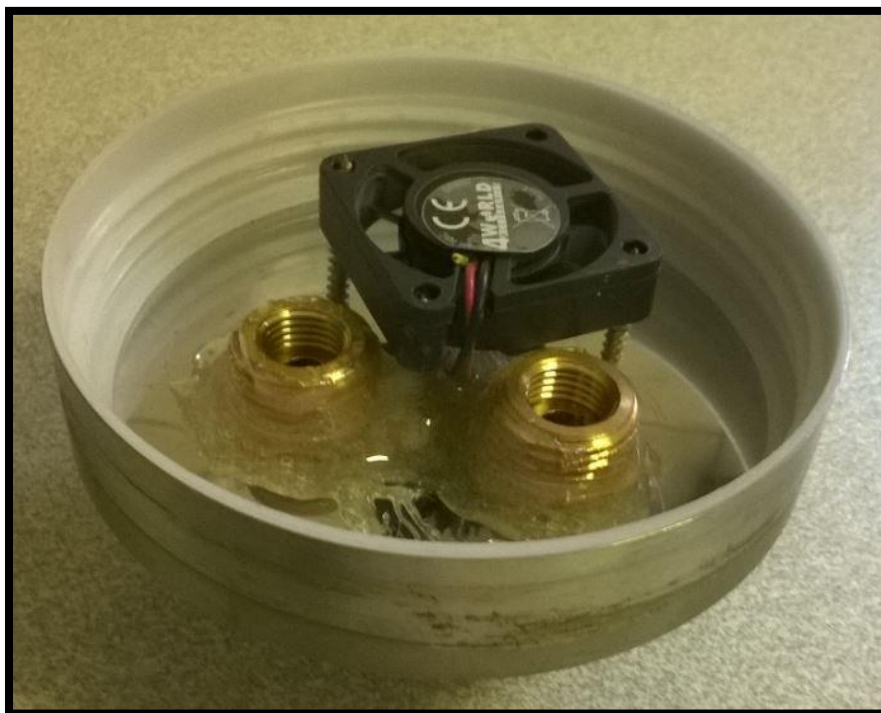
5.1.2.-1. ábra: Rozsdamentes acél fedél mintavevő csapokkal és 12V-os ventilátorral
