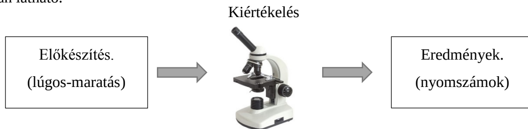
7. ábra: Mikroszkópon alapuló kiértékelő módszer sematikus ábrája.
