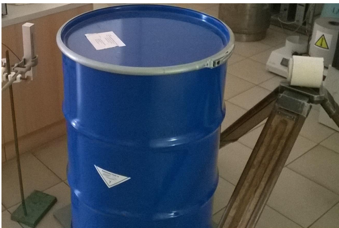
17. ábra A detektor, a hordó és a sugárforrás helyzete
